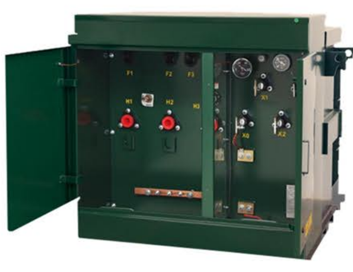
Tipo: Frente muerto Conexión: Radial (Paralelo) Anillo (Serie) Temperatura: Sobreelevación de temperatura de 65° C y en tipo costa 55°C Tanque: Acero al carbón y/o Acero inoxidable. Enfriamiento: ONAN (Aceite mineral y/o vegetal FR3) Frecuencia: 60 Hz. Recubrimiento: Pintura en polvo por método electroestático 3 mills de espesor.
